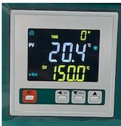
Рисунок 8 — рабочий экран регулятора: TIME — время выдержки, PV — измеренная температура 20,4 °C, SV — заданная температура 150,0 °C, значок RUN — регулятор работает
