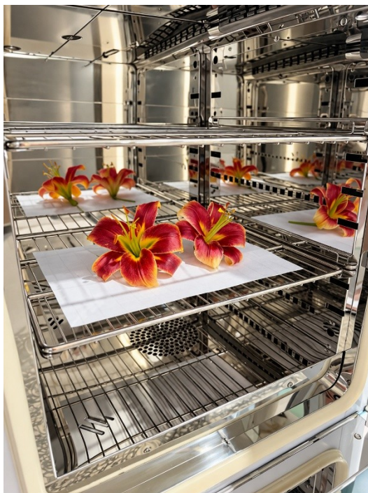
Рисунок 6 — рабочая камера из зеркальной нержавеющей стали с направляющими рамками для установки полок
