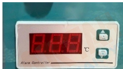
Рисунок 10 — независимый ограничитель температуры Alarm Controller: индикатор порога и кнопки ▲ / ▼
