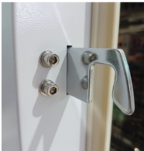
Рисунок 3 — запорный узел дверцы: прижим регулируется винтами крепления замка
